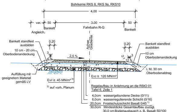
1) Auf Planumsniveau ist ein Ev2 von mind. 80 MN/m2 zu erreichen. Bei Nichterreichen der geforderten Tragfähigkeit auf Planumshöhe ist gemäß Baugrundgutachten vom 18.05.2022 (ILG Gießen) die Dicke der Frostschutzschicht entsprechend zu erhöhen bzw. Bodenverbesserungsmaßnahmen durchzuführen.
